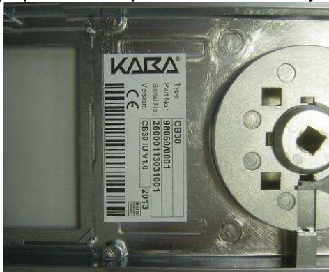
Obrázek 7: Štítek s výrobními daty ve vstupní jednotce - klávesnici
