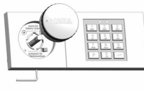
Obr. 6.2: Odstraňte otočný knoflík.
